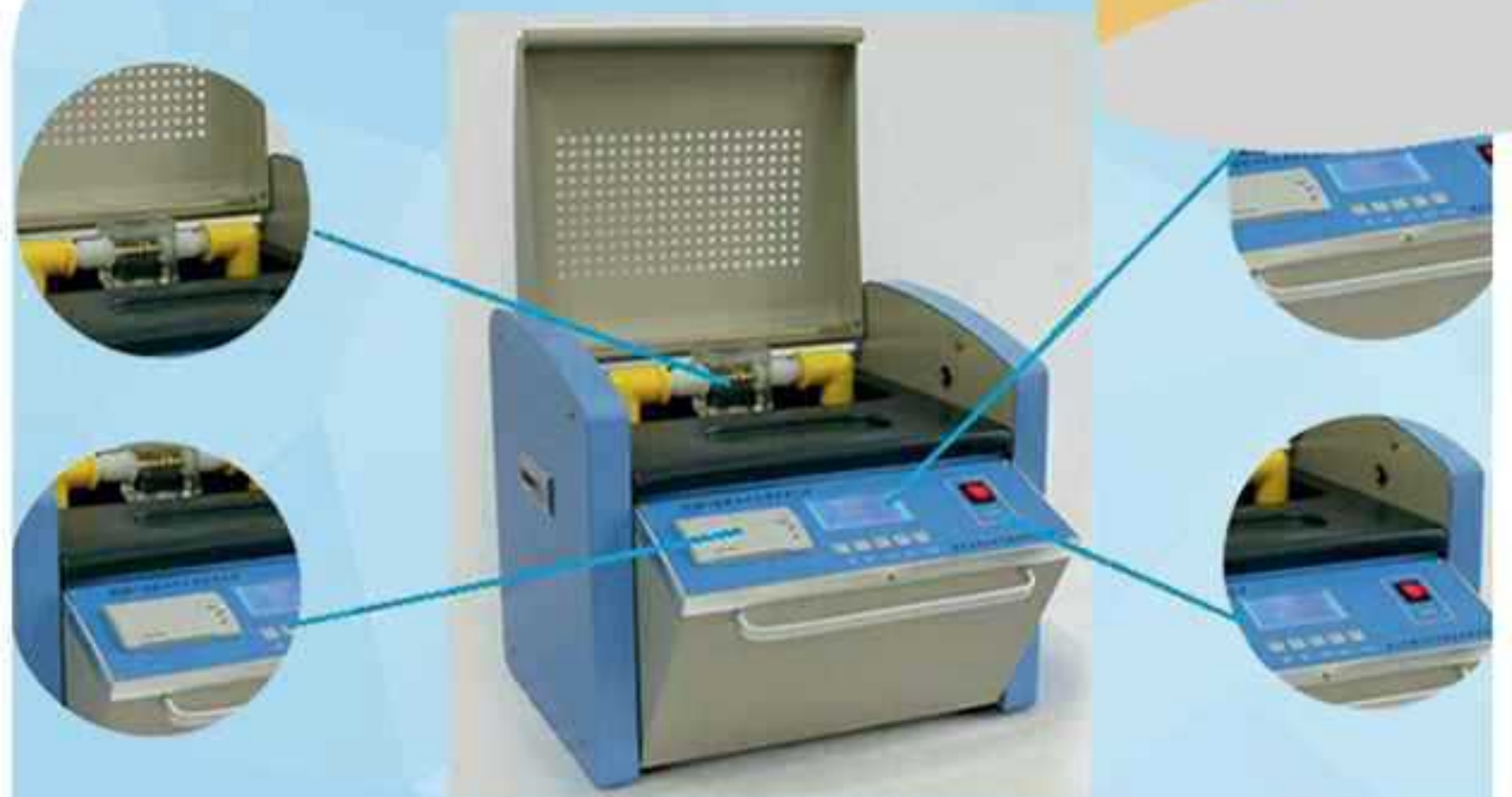
دستگاه تست روغن ترانسفورماتور
